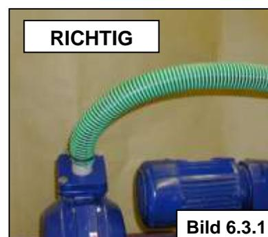
Der Anschluss erfolgt standardmäßig mit flexiblem Schlauch und Schlauchschellen, bei Sonderausführungen über Getränkeohrverschraubung, Kamlok-Kupplung, Normflansch etc.
