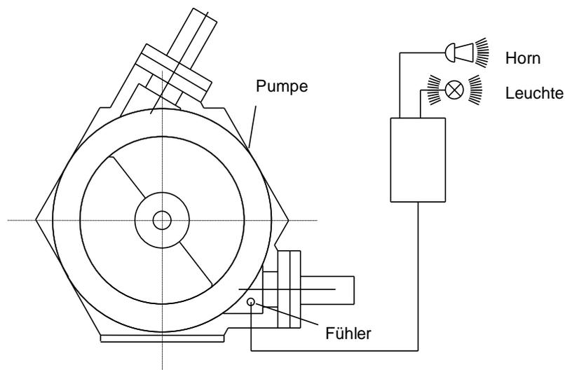
**Die nachfolgend aufgeführten Schlauchbruchüberwachungen stehen optional zur Verfügung:**
