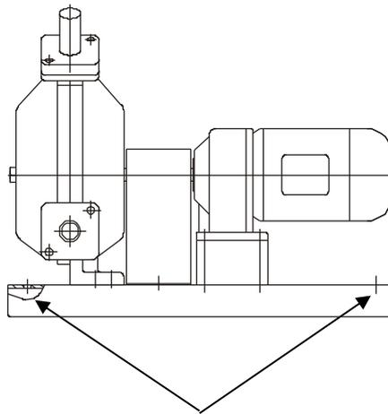
**Bohrungen zum Heben der Pumpe
