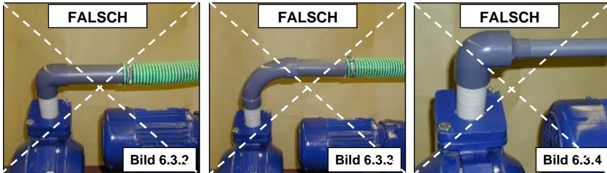
Bei der Installation sollten zur Vermeidung von Druckspitzen, die den Pumpenschlauch schädigen können, keine 90° Winkel oder Bögen direkt hinter der Pumpe montiert werden (siehe Bild 6.3.2 und 6.3.3).
