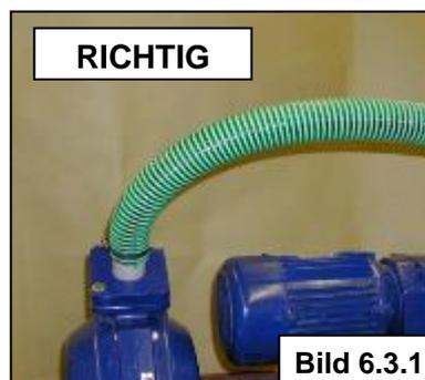
Der Anschluss erfolgt standardmäßig mit flexiblem Schlauch und Schlauchschellen, bei Sonderausführungen über Getränkerohrverschraubung, Kamlok-Kupplung, Normflansch etc.
