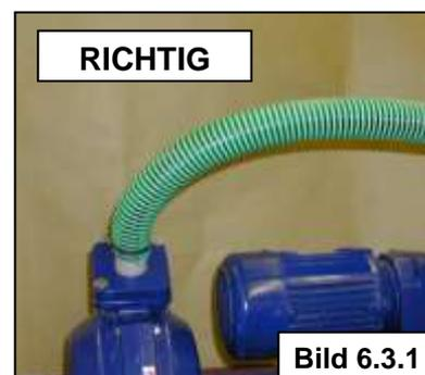
Der Anschluss erfolgt standardmäßig mit flexiblem Schlauch und Schlauchschellen, bei Sonderausführungen über Getränkeohrverschraubung, Kamlok-Kupplung, Normflansch etc.
